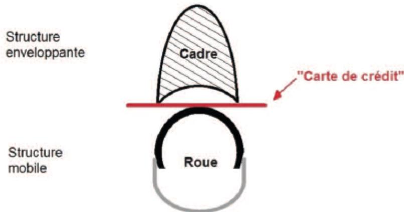
moyen pratique pour vérifier l'existence d'un carénage sur une pièce mobile comme la roue :
