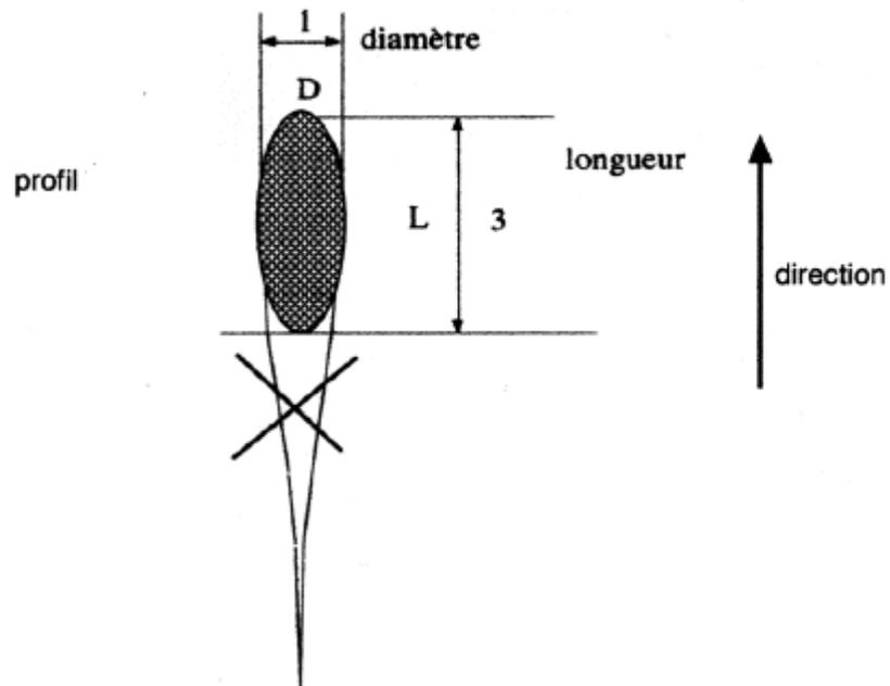
Le fuselage consiste à allonger ou effiler un profil. Le fuselage est toléré dans la mesure où le rapport de la longueur  $L$  au diamètre  $D$  ne dépasse pas 3. Cette règle ne s'applique pas au cadre ni à la fourche de la bicyclette.
